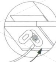
После полной зарядки батареи плотно закройте заглушку разъёма зарядки
